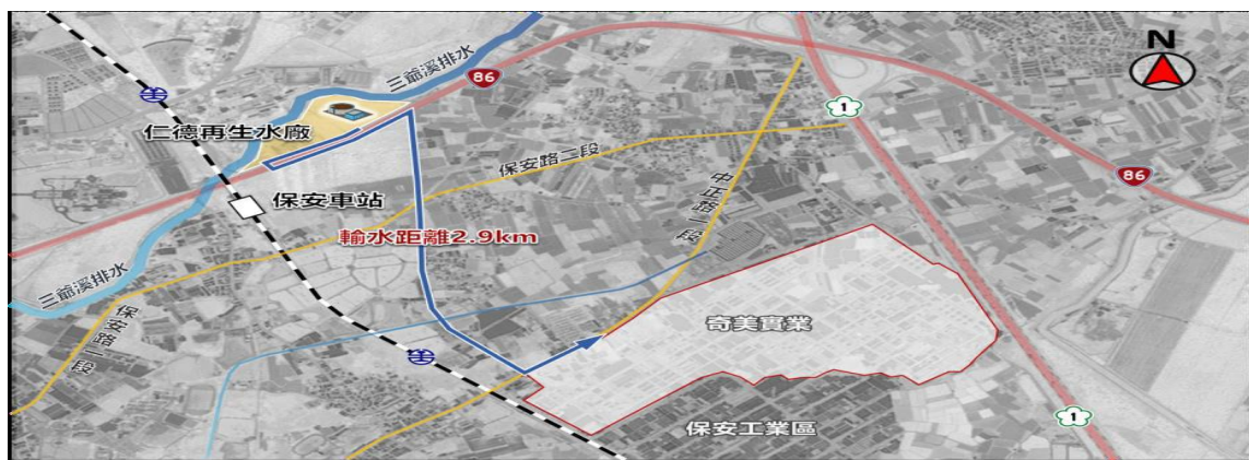
圖 3-10 仁德廠及輸送管線配置示意圖
