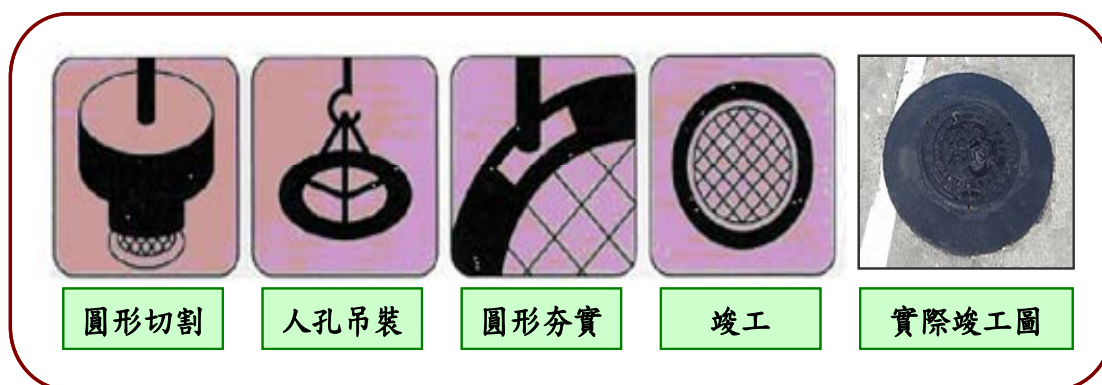
圖 3.90 人孔蓋 EPO 機械工法
