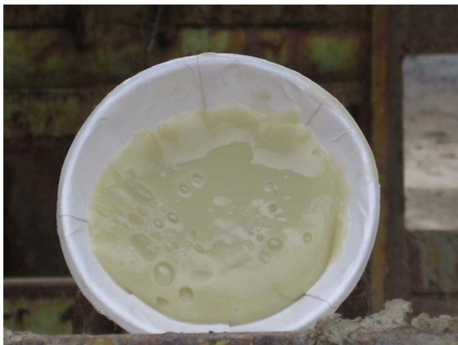
圖 2-7 固結型滑材凝固後之型態
