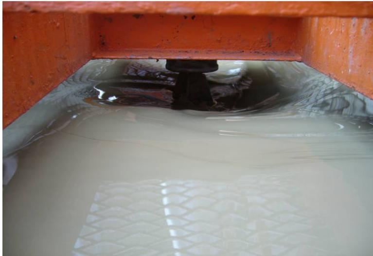
圖 5-27 泥水式工法添加材攪拌情形
