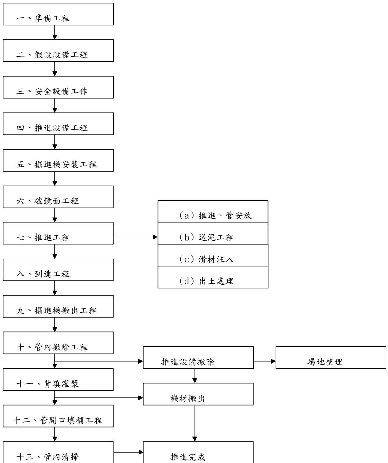
圖 5-1 泥濃式施工流程圖
