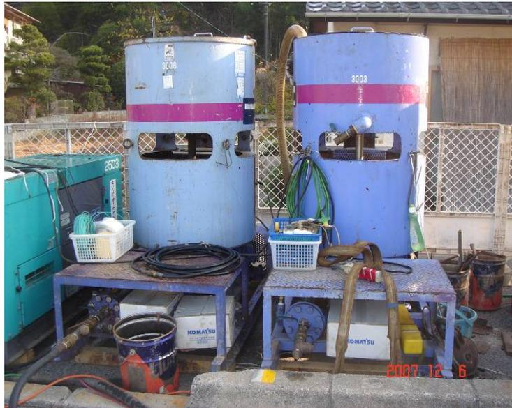
圖 5-14 土壓式工法注入材攪拌設備
