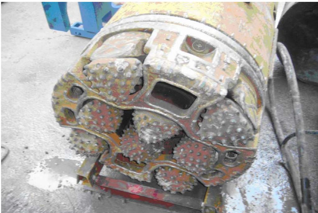
圖 2-18 泥水式工法-卵礫石或岩盤破碎型掘削機頭
