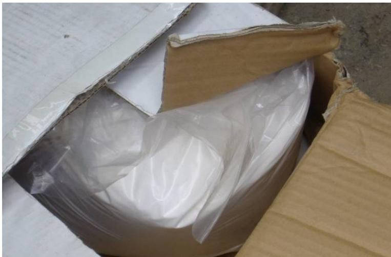
圖 5-26 泥水式工法掘削添加材
