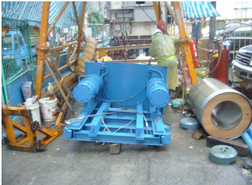
圖 5-24 泥水式工法推進千斤頂機台
