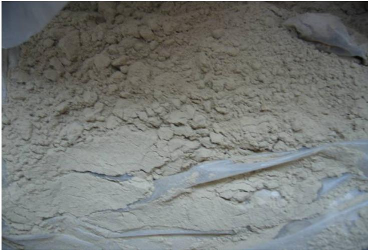
圖 5-17 土壓式工法掘削添加材
