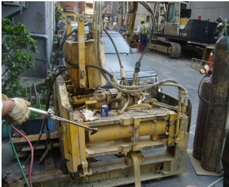
圖 5-13 土壓式工法推進千斤頂機台
