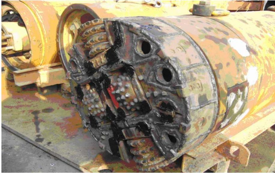
圖 2-14 土壓式工法-卵礫石或岩盤破碎型掘削機頭
