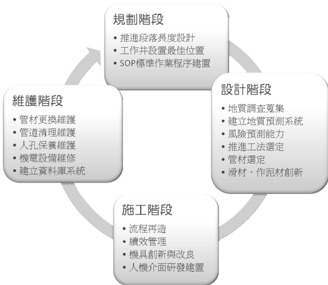
圖 2-48 下水道推進作業生命週期。
