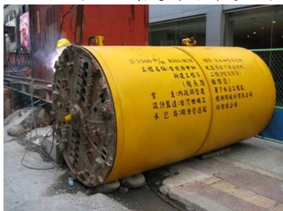
圖 2-10 案例調查：泥水加壓式掘進機（官良民等人，2008）
