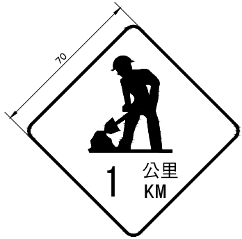
道路施工標誌 施 1
