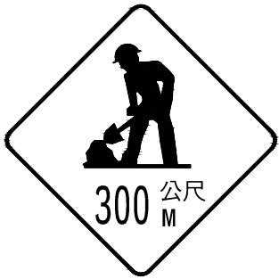
道路施工標誌 施 2
