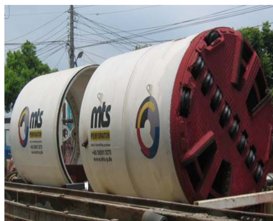
圖 2-56 泥水加壓式掘進機 （機頭長度：4560 mm） （藍啟榮等人，2008）
