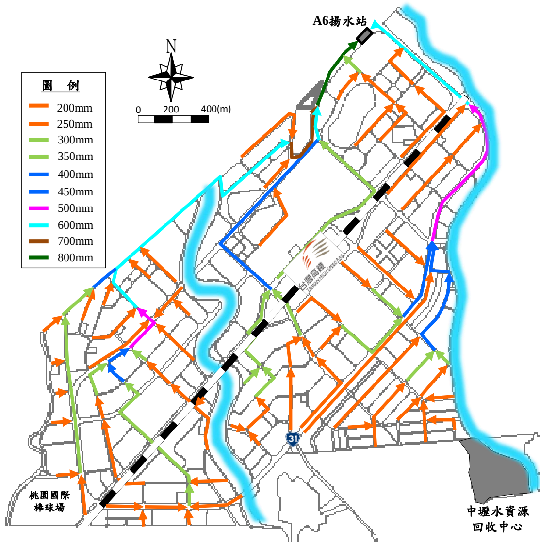
圖 3.4-6 高鐵特定區既設污水管線位置圖
