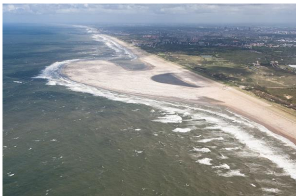
荷蘭鹿特丹和海牙間的海岸利用養灘增加了原本狹窄的沙丘群強度，以鞏固灘岸。
