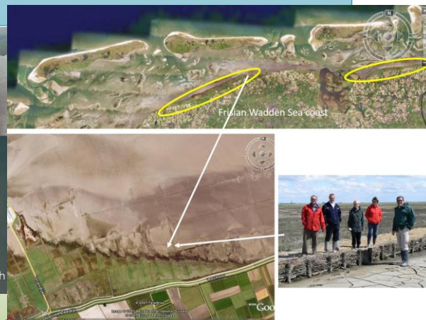
荷蘭瓦登海沿岸堤防受鹽沼的保護，這些鹽沼是由成排的柳樹枝條產生自然沉積所形成的。
