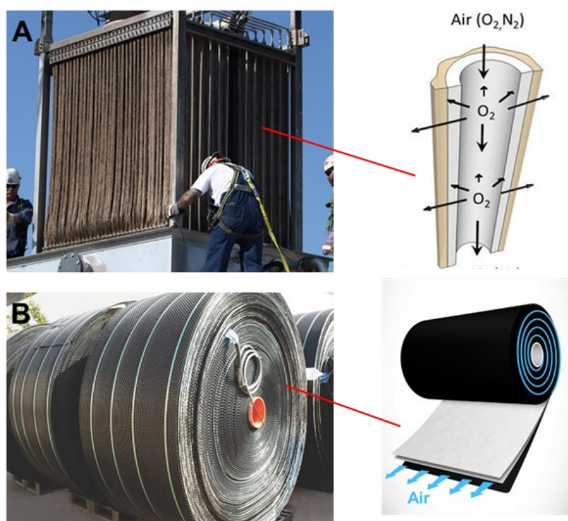
圖 3 MABR 膜類型，A.中空纖維膜 [6]，B. 纏繞式螺旋膜 [7]
