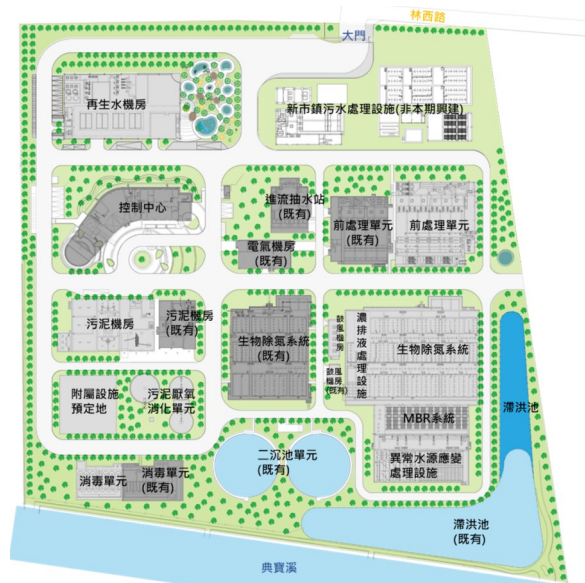
圖 16 岡橋污水廠及橋頭再生水廠配置圖
