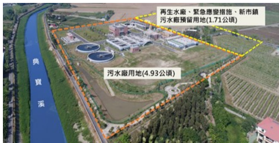
圖 14 岡橋污水廠及橋頭再生水廠範圍圖
