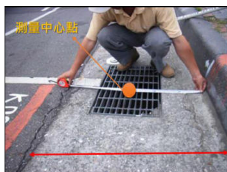
若側溝無法開啟，則以側溝至道路寬度減去20cm為依據(如上圖)
