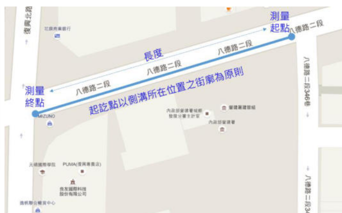
若側溝無法開啟，則以側溝至道路寬度減去20cm為依據(如上圖)
