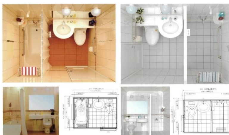
圖 5-3-5 整體衛浴設備配合空間模矩化沐浴方式可採用澡盆或淋浴 （資料來源：卜大整體衛浴）
