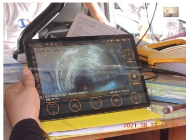
圖 7、下水道水位影像與管渠 CCTV 檢視 AI 辨識應用
