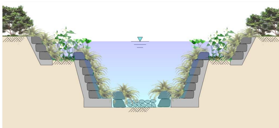
圖 3.5-4 排水斷面建議示意圖
