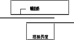
B. 搭接輔助鋼筋
