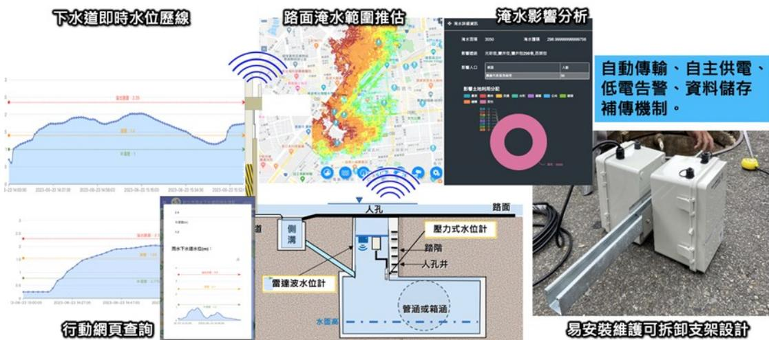
圖3 雨水道水位計安裝與應用
