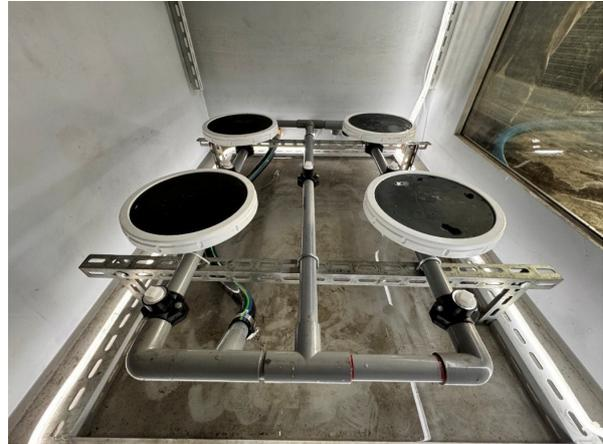
圖 2 曝氣測試水槽內部與散氣裝置
