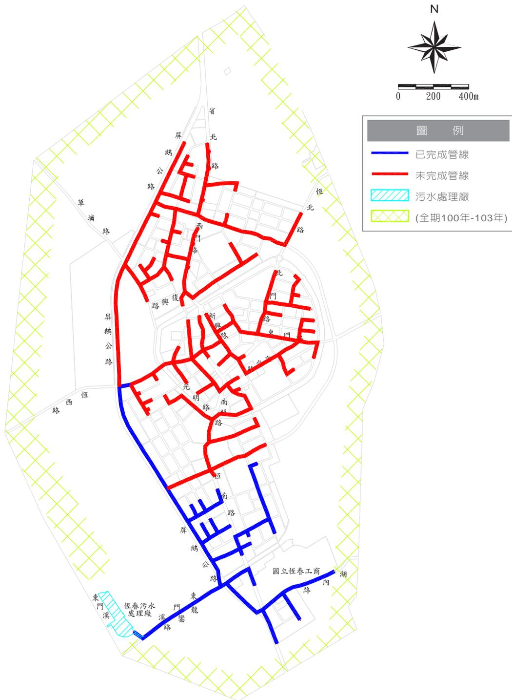
圖53 屏東縣恆春地區污水下水道系統建設圖
