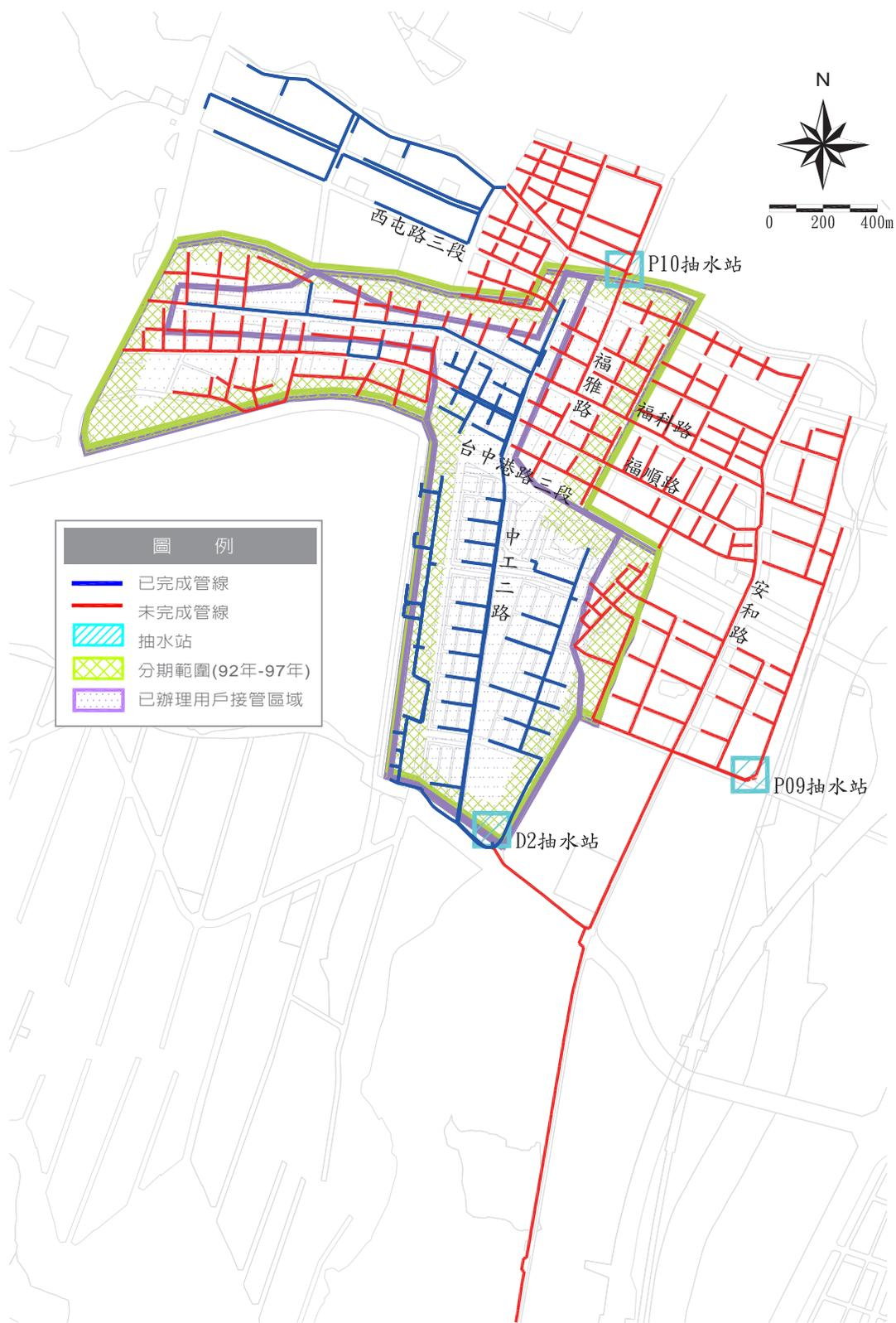
圖63 臺中市工業區鄰近區域污水下水道系統建設圖
