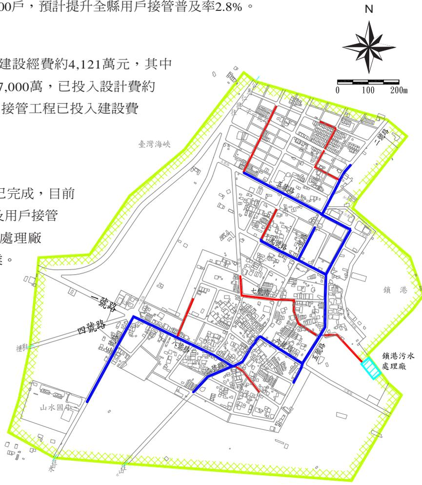
圖58 澎湖縣鎖港地區污水下水道系統建設圖
