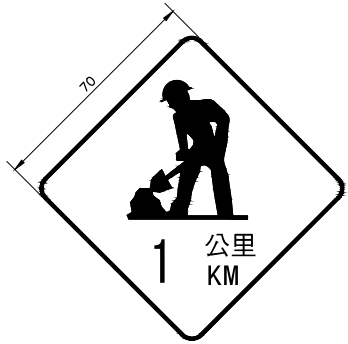
道路施工標誌 施 1
