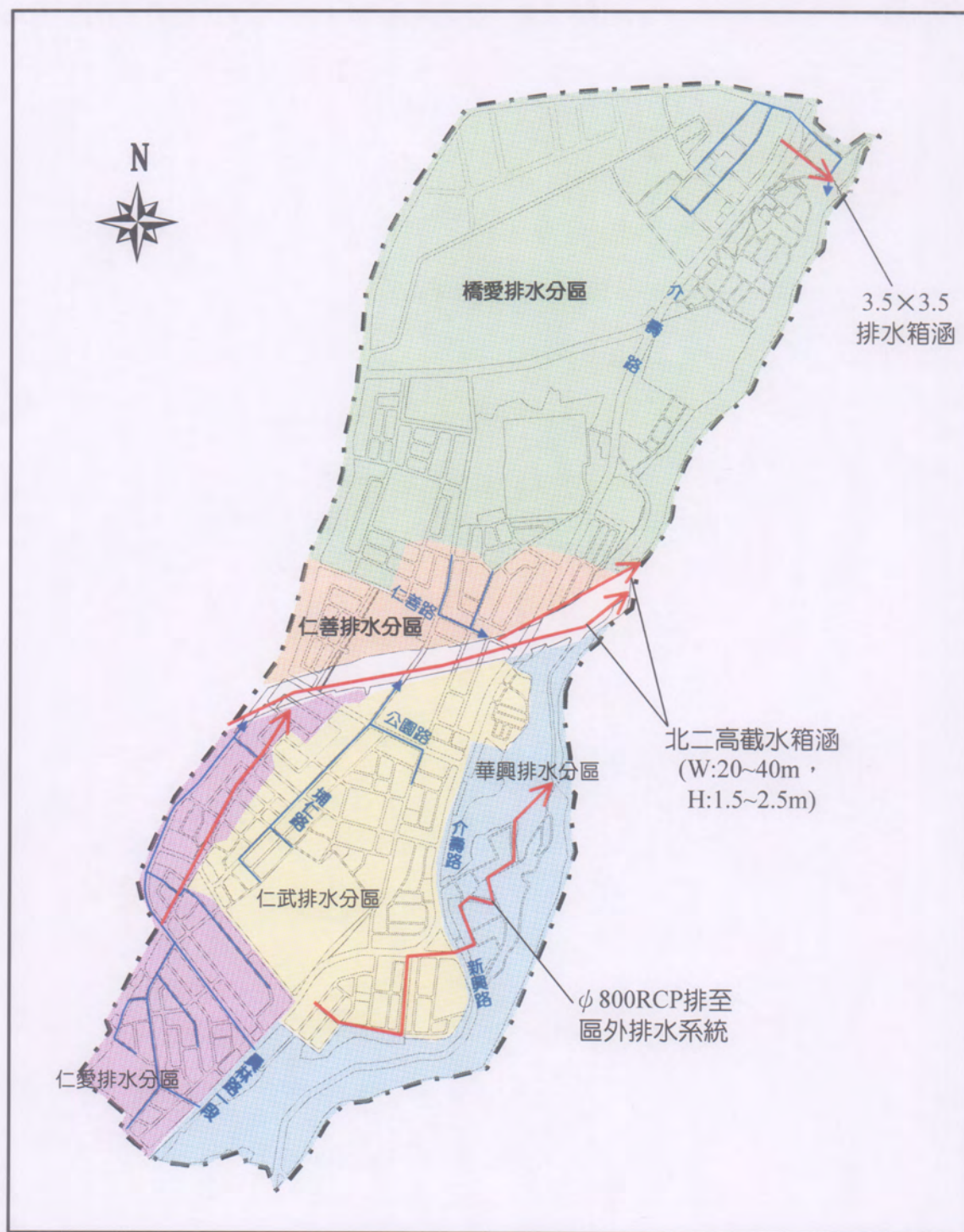
圖 1.4-12 埔頂都市計畫區排水系統示意圖
