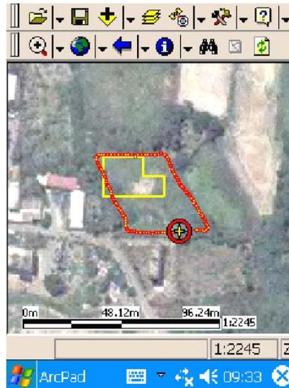
圖 9.3.2.3-1 使用單頻差分型全球定位系統所定位之變異點形狀與位置
