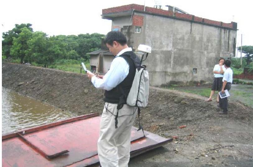
圖 9.3.2.3-2 使用單頻差分型全球定位系統之現場勘查照片
