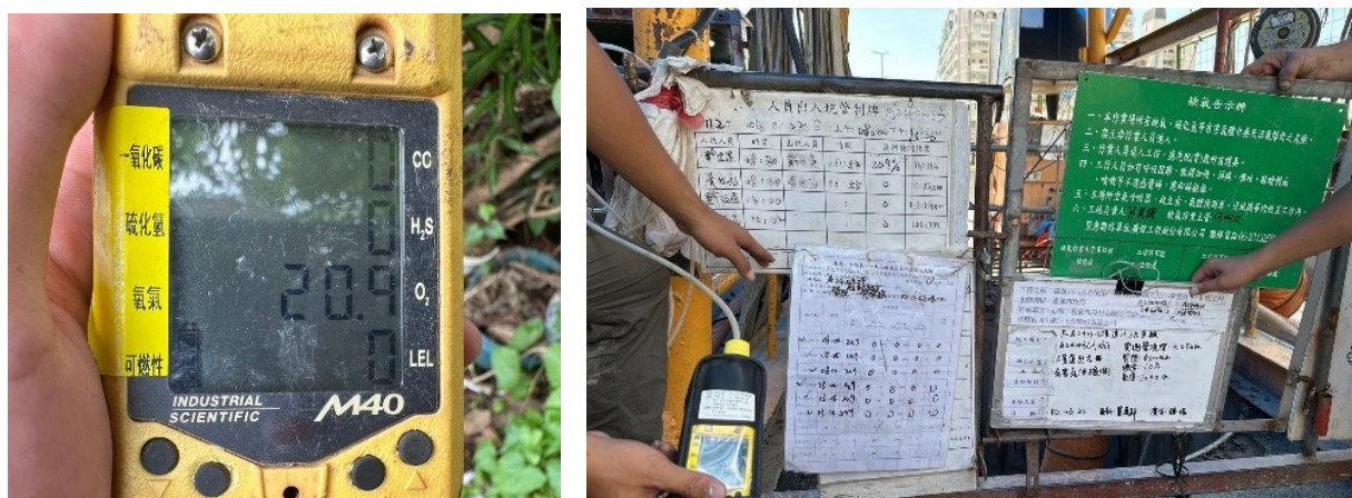
圖 6 M40 四用氣體偵測器（左）、作業前偵測氣體數值紀錄且期間全時偵測（右）
