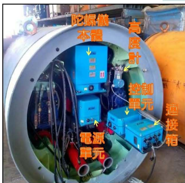
圖9 陀螺儀安裝完成示意圖
