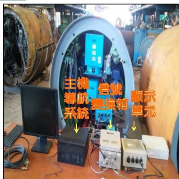
圖10 導航系統完成示意圖
