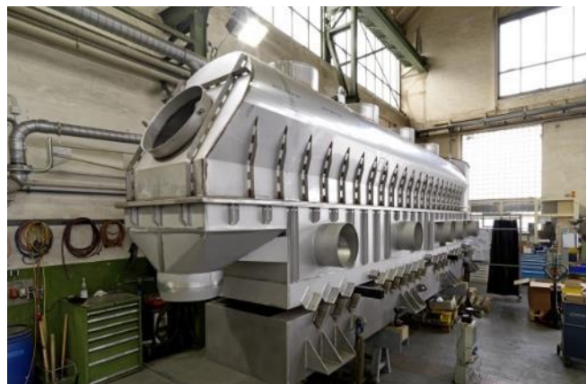
圖 10.65 流化床式乾燥機示意圖
