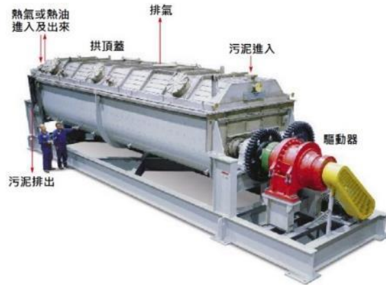
圖 10.63 漿葉式乾燥機示意圖
