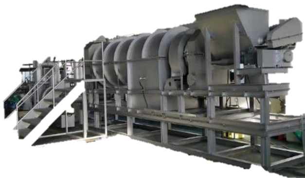
圖 10.61 旋轉式干燥機示意圖
