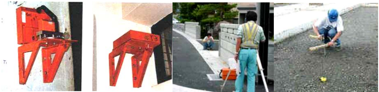
圖 4.2-19 安全監測設備傾度盤及沉陷釘示意圖
