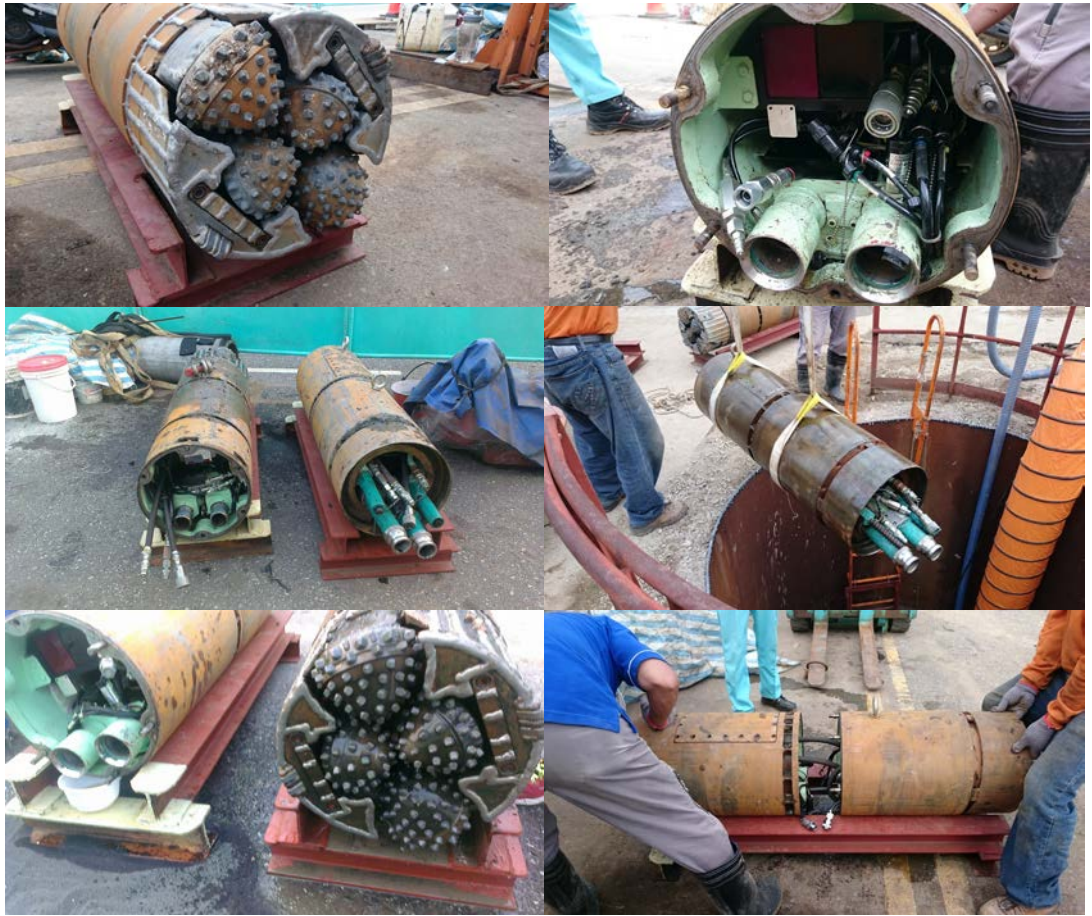
圖 4.3-6 推進施工機具圖
