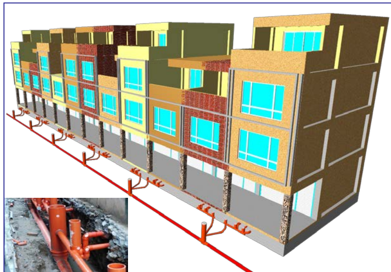
圖 4.4-8 B 模式接法配置及施工概況
