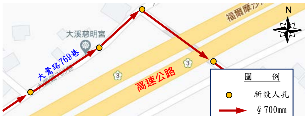
圖 4.2-11 主幹管自下方穿越高速公路平面示意圖
