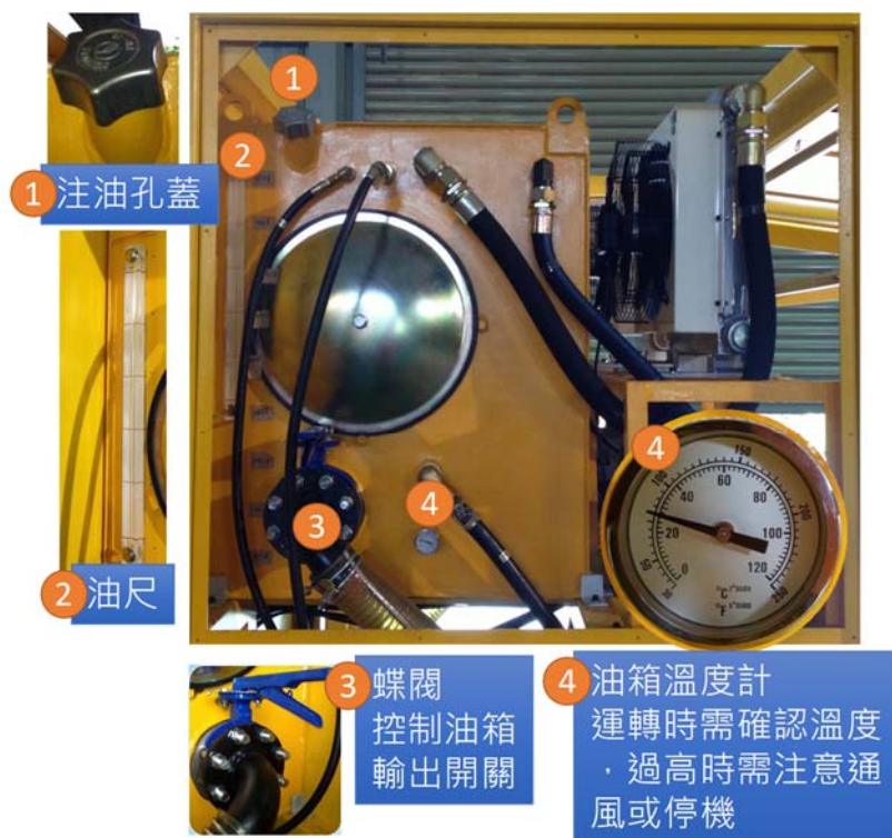
圖 2.3-7 動力系統介面示意圖
