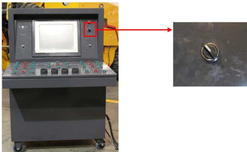
圖 2.5-3 操作臺電源開關示意圖
