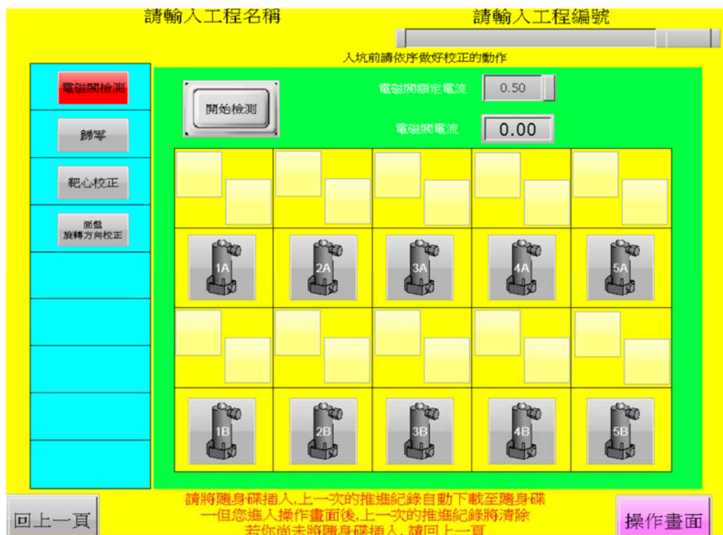
圖 2.8-3 電磁閥檢測示意圖
