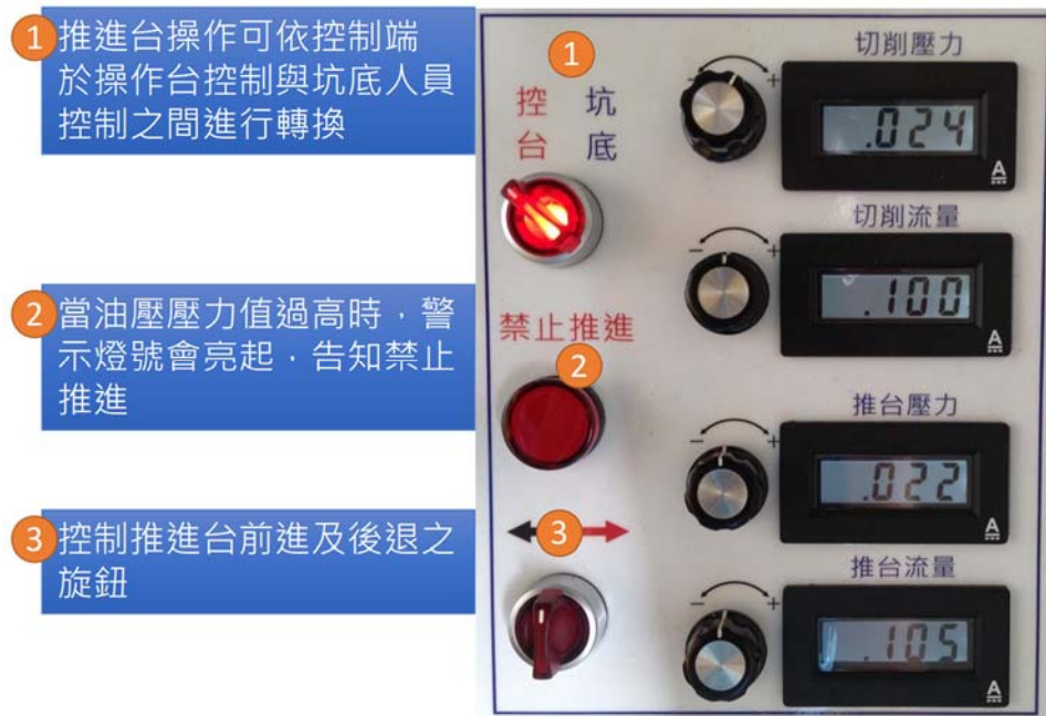
圖 2.3-6 推進台操作系統示意圖
