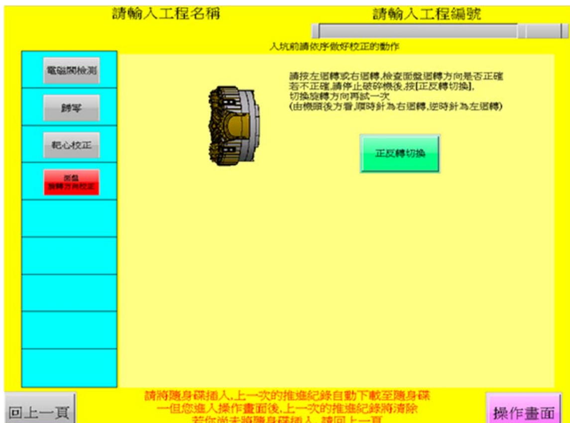
圖 2.8-7 面盤旋轉方向校正示意圖
