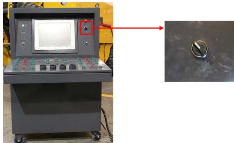
圖 3.3-4 操作臺電源開關示意圖
