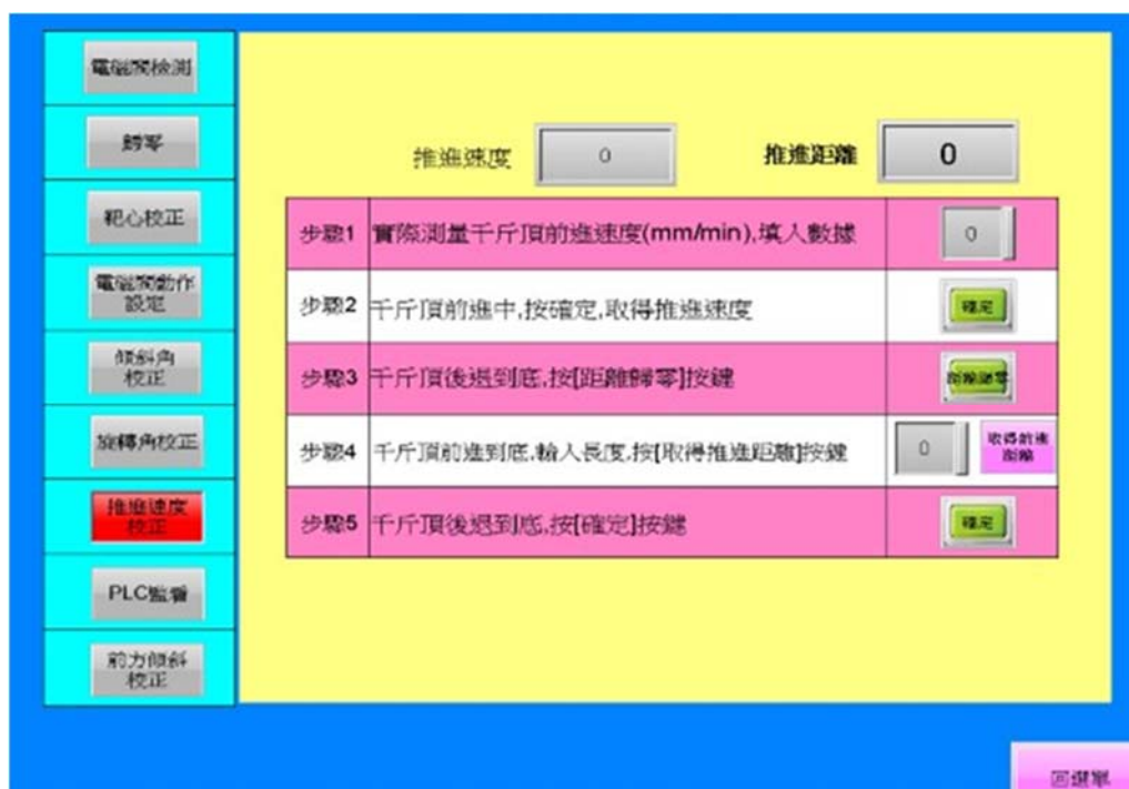
圖 2.8-26 推進速度校正區示意圖
