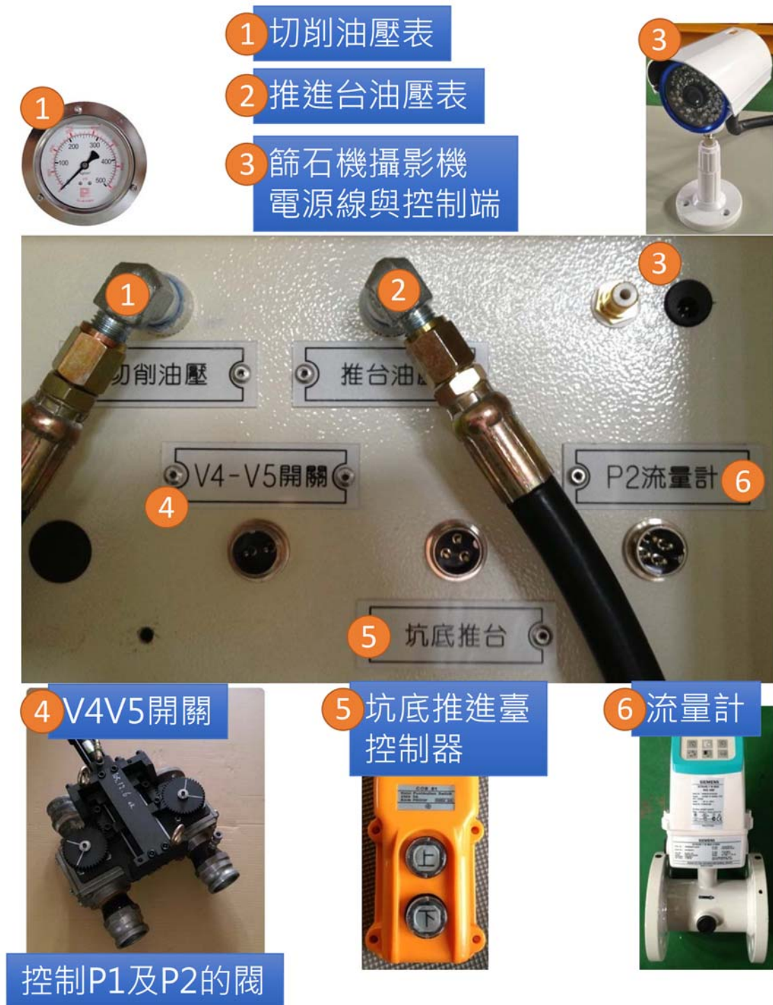
圖 2.3-2 操作台電源插座介面圖
