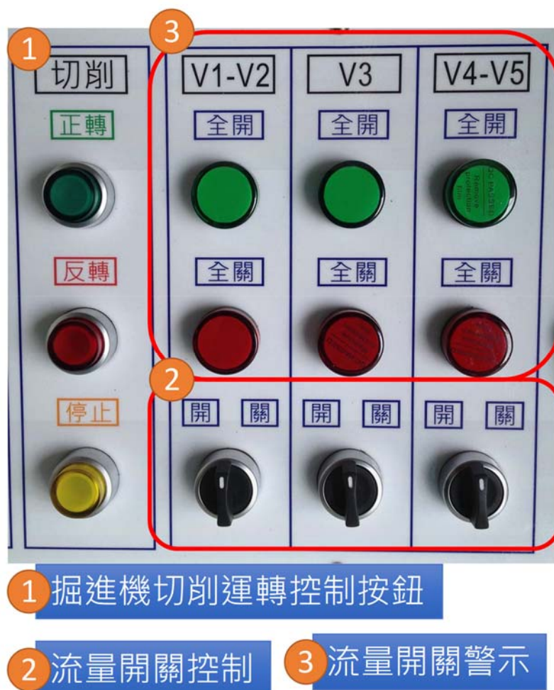
圖 2.3-4 切削與流量開關介面示意圖
