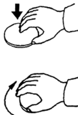
圖 3.3-9 緊急停止開關操作示意圖
