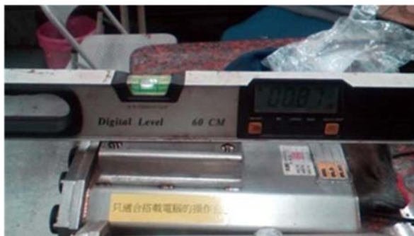
圖 2.8-24 電子水平尺水平方向校正示意圖
