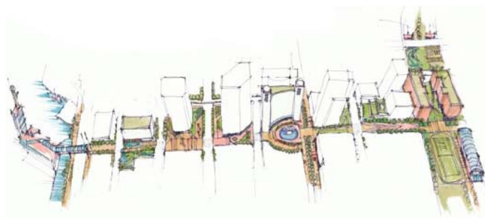
▲圖 23，Open Space 2100 Seattle 多功能的開放空間概念圖 兼具社區開放空間營造與暴雨調節功能的綠色基礎公共建設（資料來源： http://open2100.org/ ）
