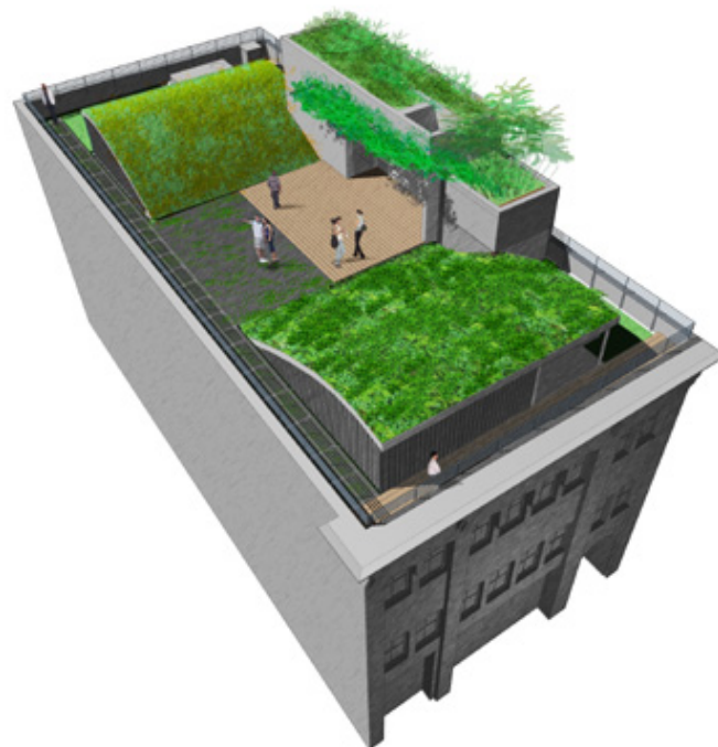
▲圖 3-6-3，波形量體與鋁製格架之結合
