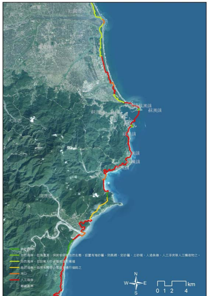
圖 3-3 各海岸段的劃設依據示意圖-以蘇澳段海岸為例
