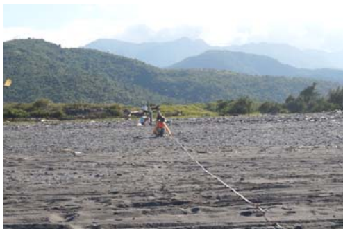
學生利用簡易測線進行距離量測
