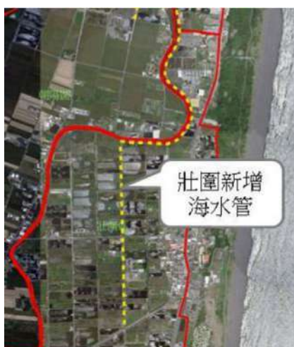
圖 48 (上) 壯圍養殖漁業生產區新增海水供管線位置
