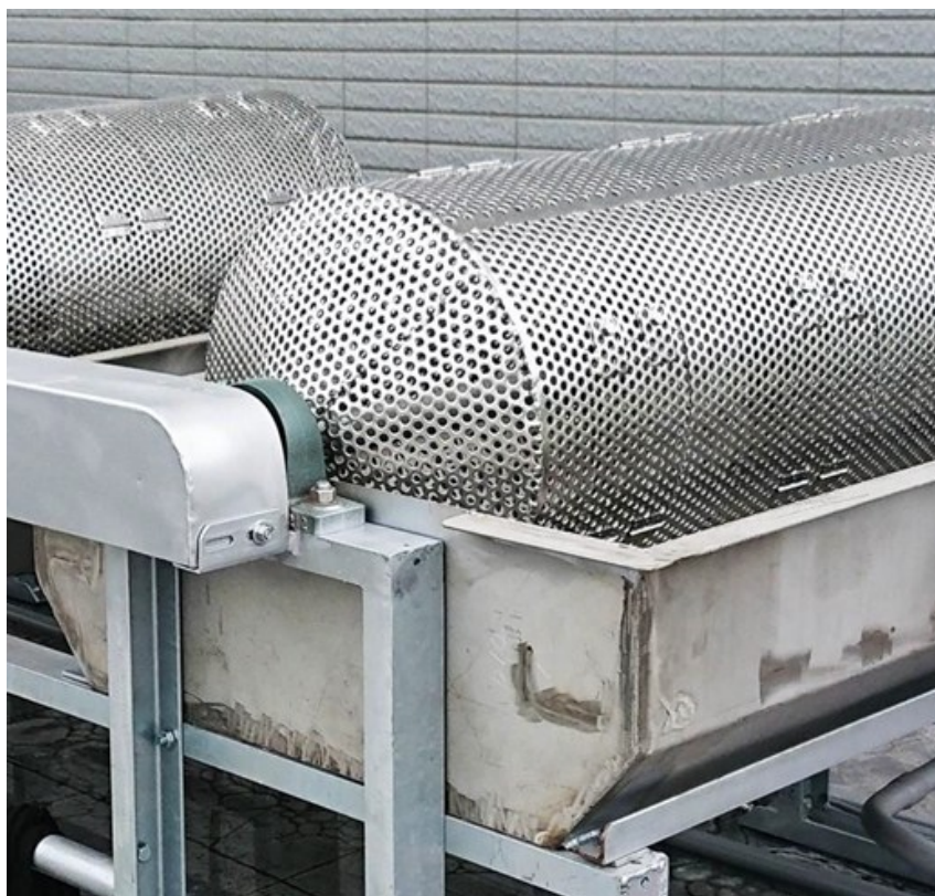
圖3 旋轉包埋生物反應器(REBC)模廠試驗
