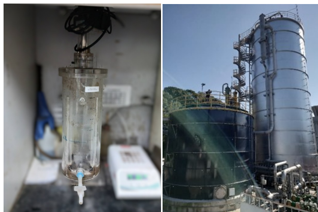
圖 1 試驗級反應槽示意圖(左)、實績化厭氧系統(右)
