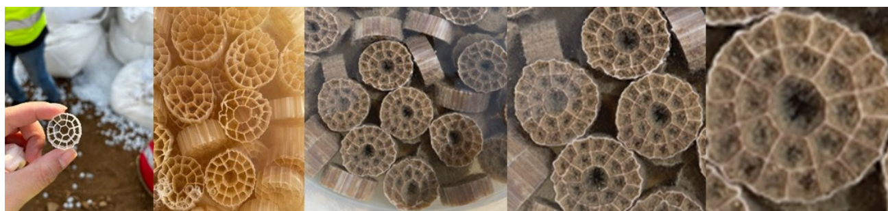
圖 1 本案 MBBR 生物載體與生物膜的生長情況
