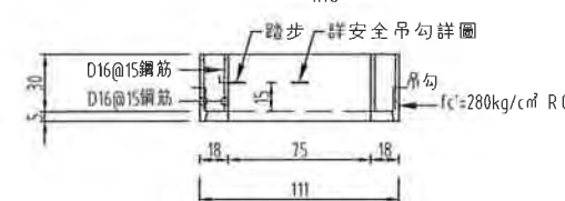
預鑄短管(內徑75cm-B型)詳圖 NTS
