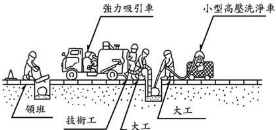
▲ 圖2.3-2 雨水井清理作業示意圖
