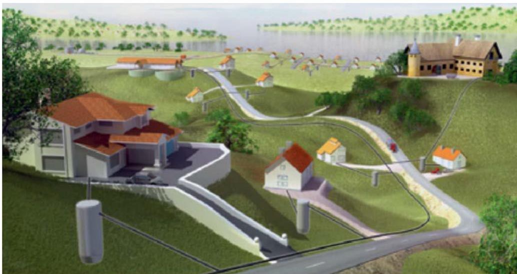
圖 3.16 壓力式污水下水道收集系統概念圖
