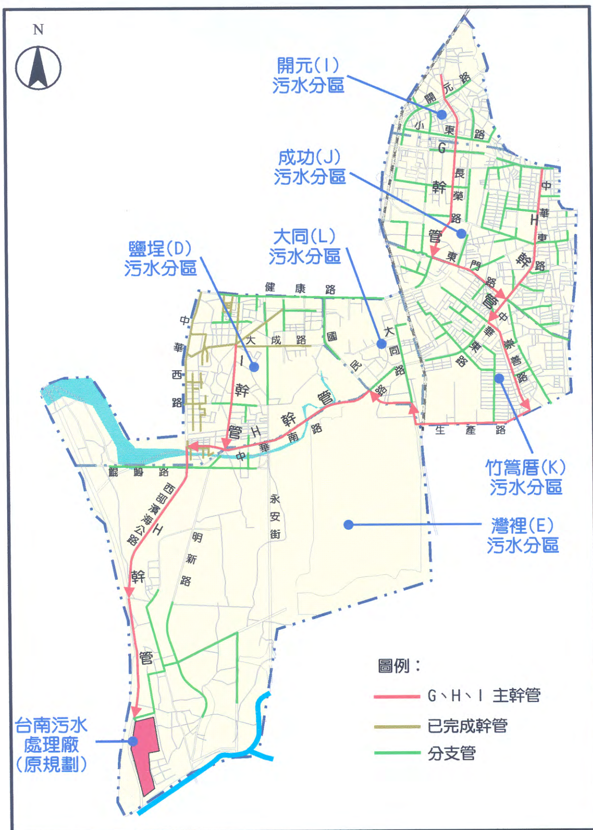
圖 1.4.2.1-1 台南污水下水道污水管線配置圖(原規劃)
