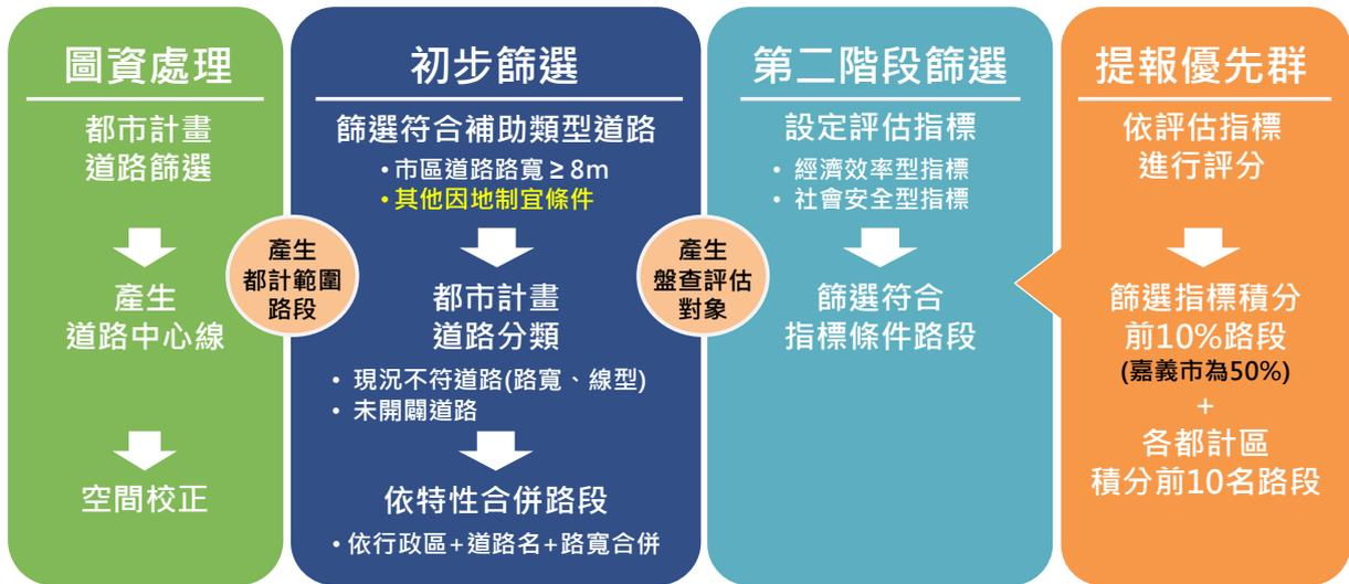
圖 3.3-2 市區道路盤查作業流程示意圖
