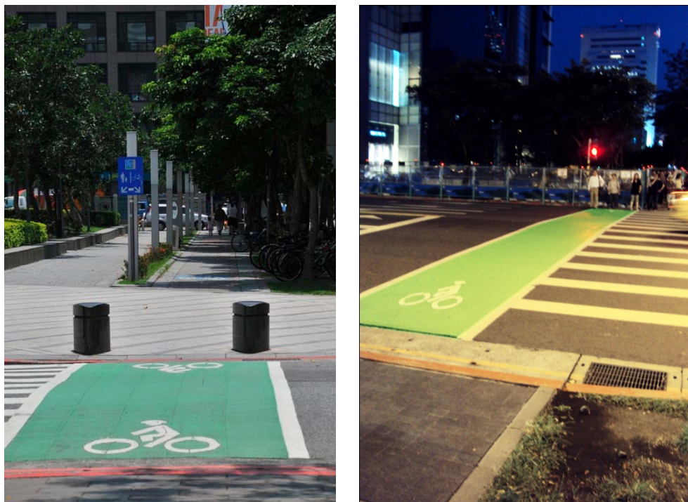
圖 2.90 穿越道採用綠色 AC 鋪面(左：日，右：夜)
