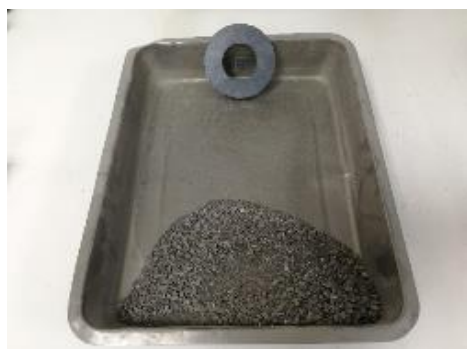
圖 4 磁吸試驗合格結果
