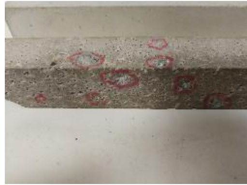
圖 7 熱壓膨脹不合格結果
