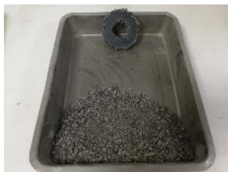
圖 5 磁吸試驗不合格結果
