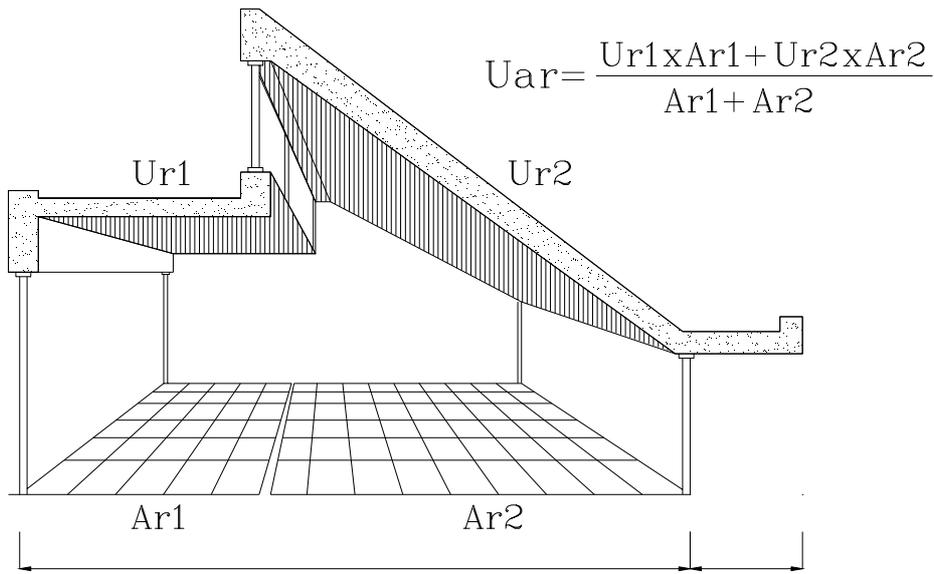
Uar 計算僅計不透光部分面積，透光部分於 Req 中規範，不再併入 Uar 計算。
