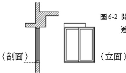
圖 6-2 開窗上緣僅有 70% 部分覆蓋水平遮陽版，則  $K_i' = 1 - (1 - K_i) \times 70\%$ 。
