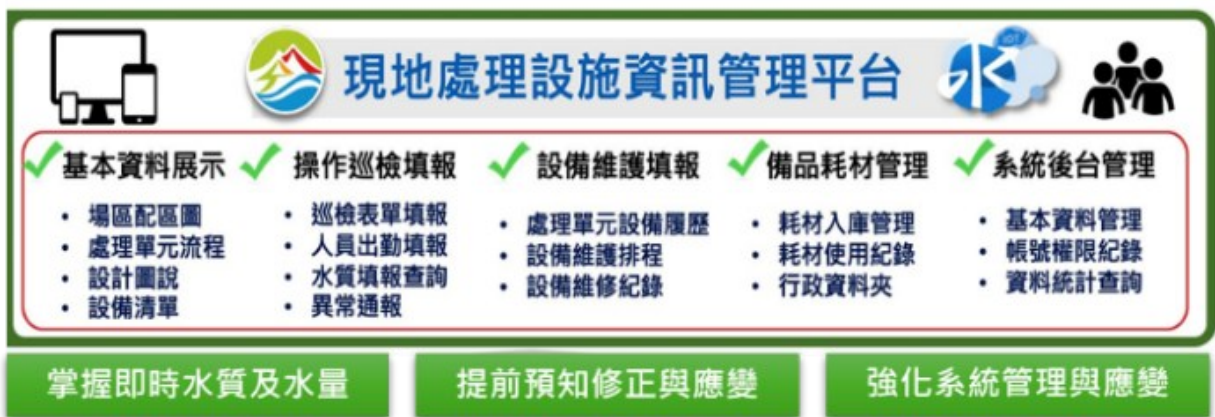
圖 13 現地處理設施整合管理平台架構圖
