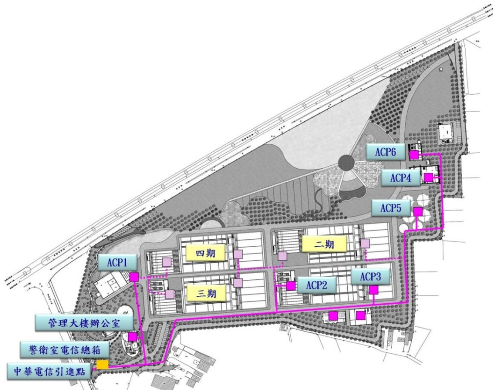
圖 6.1-16 弱電幹管初步規劃圖
