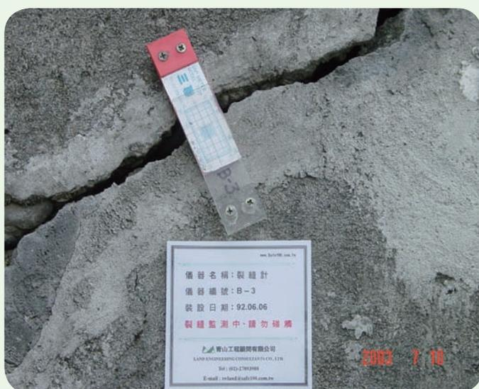
▲照片 2-4-9 利用裂縫計量測結構物裂縫寬度變化
