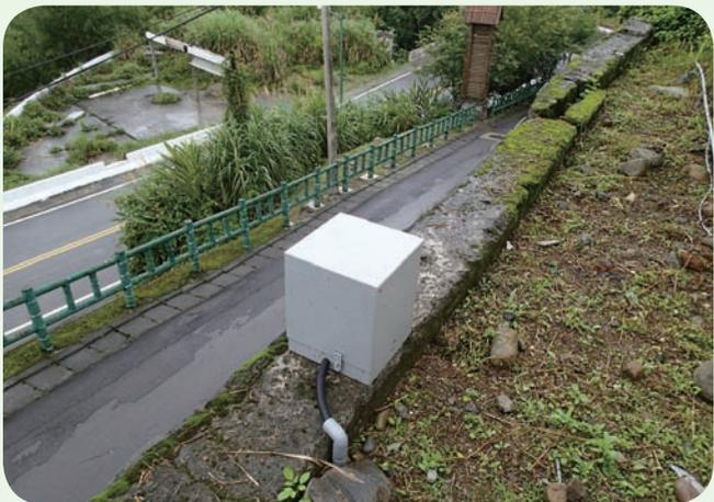
▲照片 2-4-7 電子式結構物傾度盤，可自動化量測
