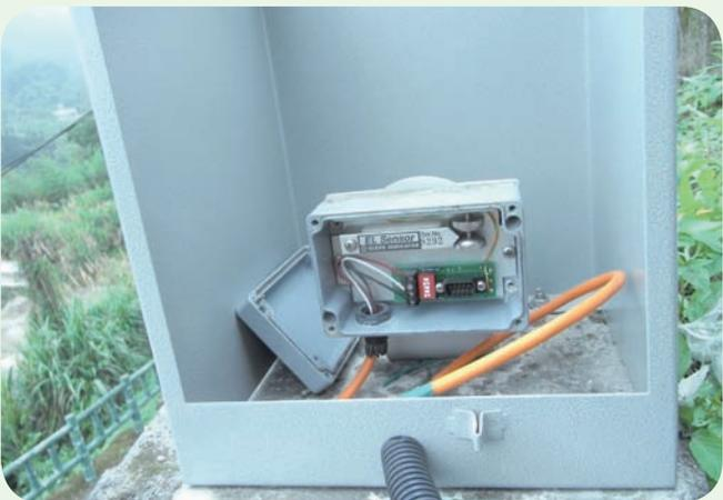
▲照片 2-4-7 電子式結構物傾度盤，內部構造
