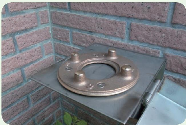
▲照片 2-4-4 結構物傾度盤照片 (手動量測)
