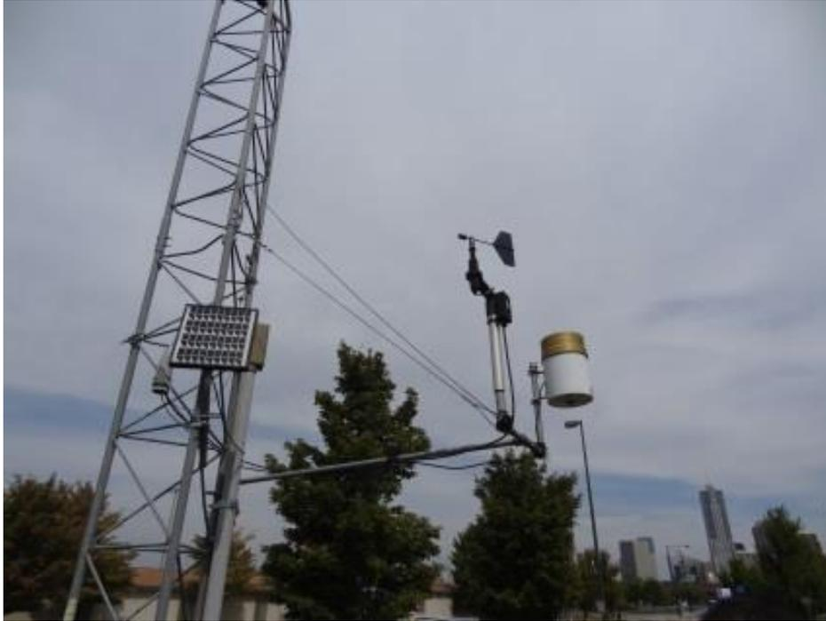
圖6-29 雨量筒與風向風速計
