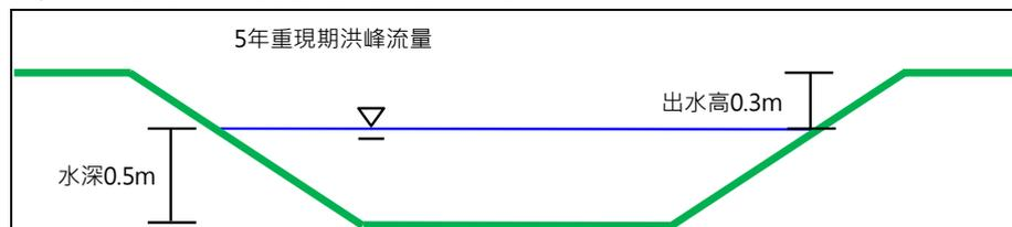
圖 6-19 植生溝傳輸 5 年重現期洪峰流量示意圖
