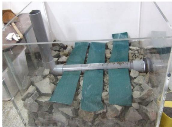
(b)鋪設礫石級配及排水管路
