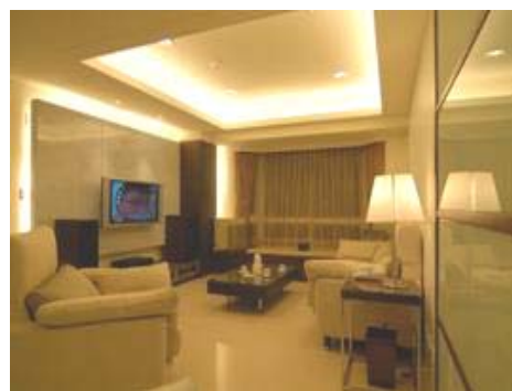
▲整建後客廳間接照明改善，光線柔和且照度充足
