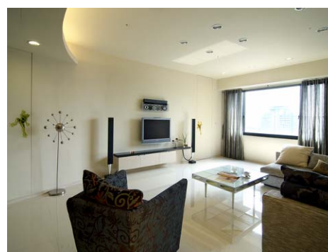
▲整建後採間接照明及明亮的天花板與牆面改善室內的照度
