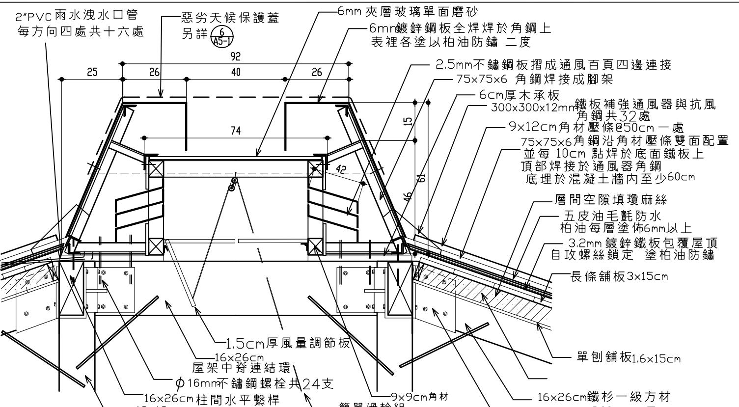
1 A5-1 壓層屋頂通風器及屋頂做法大樣 SCALE 1/15 整體說明另詳施工說明書
