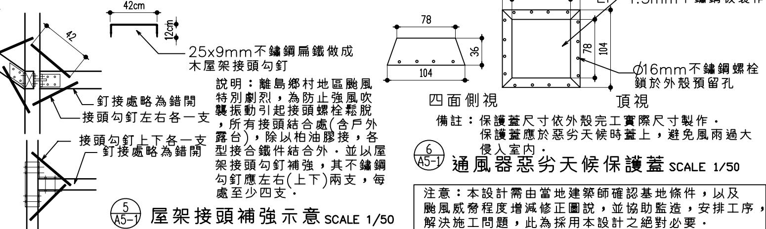
5 A5-5 屋架接頭補強示意 SCALE 1/50
