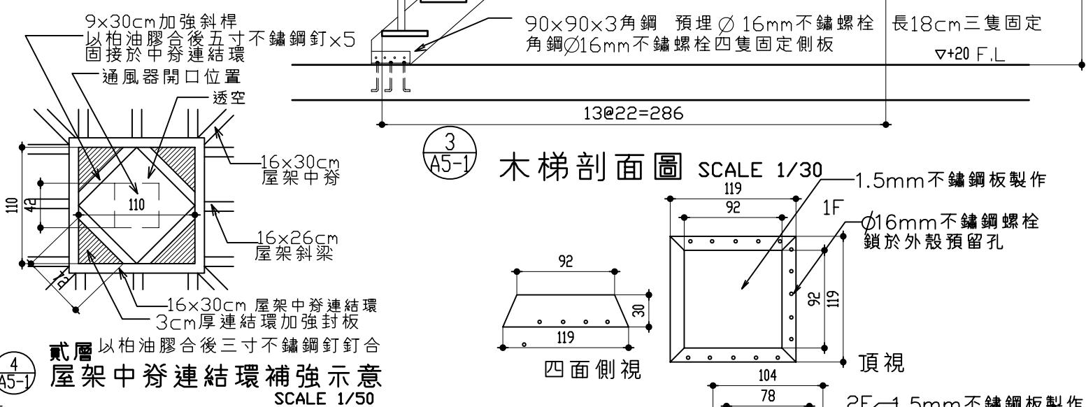
4 A5-4 貳層屋架中脊連接環補強示意 SCALE 1/50
