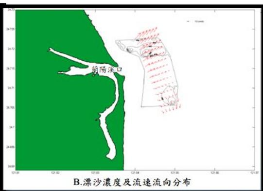
蘭陽溪輸砂懸浮載流出河口後，分別向南、北兩側海岸傳輸，往北傳輸分量大於南側。河口輸砂量與烏石漁港兩側岸線變遷無立即性的明確關係，例如2016年河口輸砂量為近年較大量，然烏石港南側岸線卻呈侵退。
