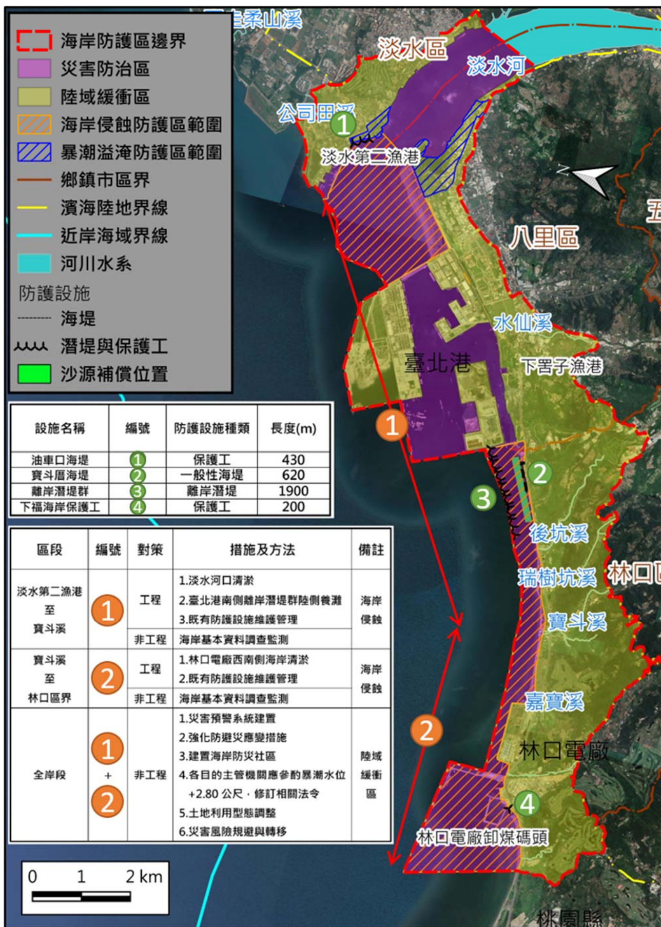
圖 7-1 新北市二級海岸防護區海岸防護設施之種類、規模及配置圖
