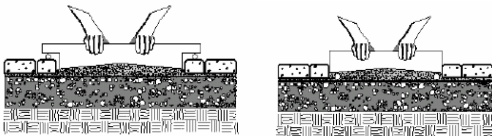
圖 2.6 黏結層回填砂鏟平方法示意圖
