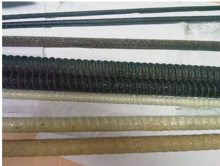
圖 3.11 FRP 棒取代鋼筋
