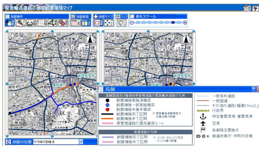
圖 4.4 緊急輸送道路橋梁耐震補強地圖
