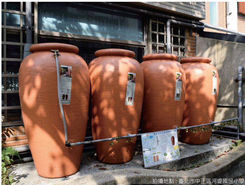
雨水桶應放置在水平墊襯上
