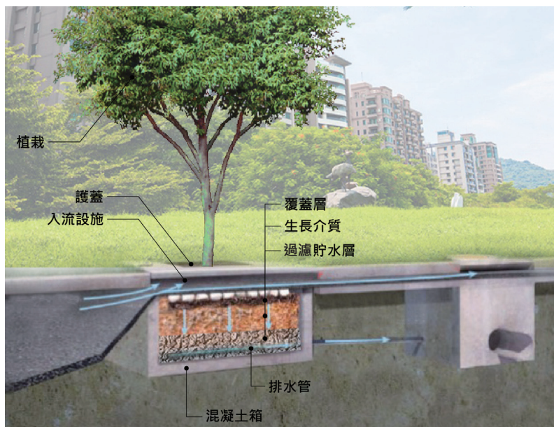
樹箱過濾設施組成結構剖面示意圖
