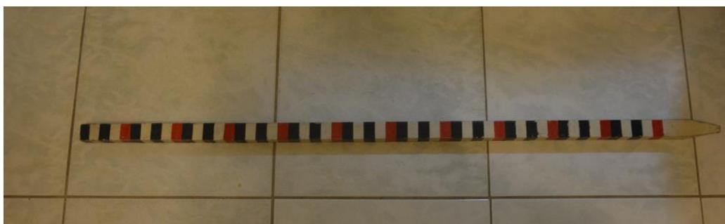
可以去木材行買角材(方便手持即可) 製作兩根測量桿(上下切平(這一支沒切平!))
