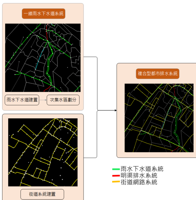
圖 1 複合型(街道/下水道)都市排水系統示意圖
