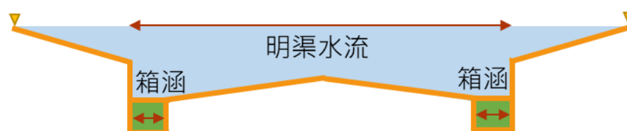
(b) 道路縱向坡降與路側溝相反或差異過大時之建議設定方法
