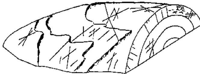
圖 17 褶皺軸附近所產的許多裂隙(Spencer, 1977)
