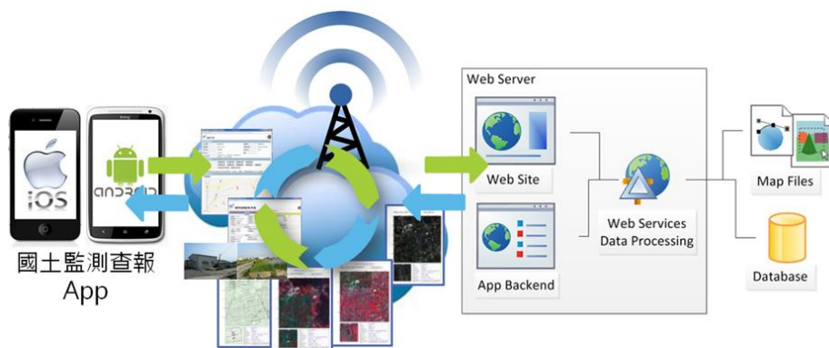
圖 27 可攜式裝置、網站伺服器及資料庫伺服器三方整合傳輸概念圖
